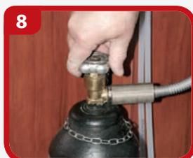
8 Откройте вентиль на баллоне CO<sub>2</sub> против часовой стрелки.
