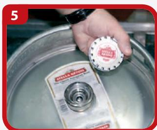
**5** Снимите контрольную пломбу. Контрольную пломбу нового кега необходимо сохранить до полной реализации пива в кега.
