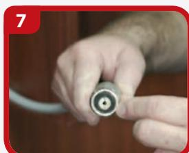
7 Проверьте наличие и целостность уплотнительной шайбы и зафиксируйте шланг на баллоне.
