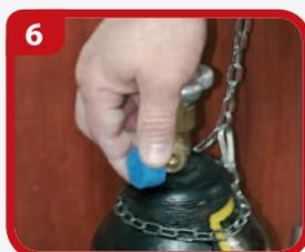
6 Снимите предохранительную заглушку с нового баллона.
