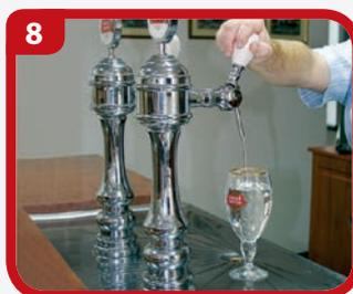
**8** Откройте кран на пивной башне и интенсивно промойте водой пивную линию.
