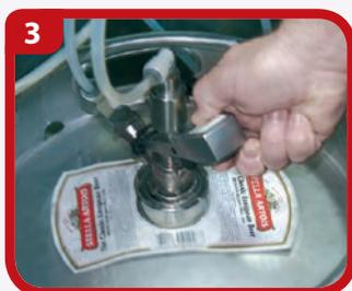
**3** Поднимите ручку заборной головки вверх до упора.
