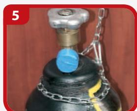
5 Зафиксируйте баллон CO<sub>2</sub> стальной цепью. **ВНИМАНИЕ:** давление газа в баллоне — 70–150 атмосфер!
