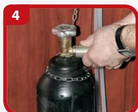
4 Отсоедините шланг высокого давления от баллона CO<sub>2</sub>. Замените пустой баллон CO<sub>2</sub> на полный.
