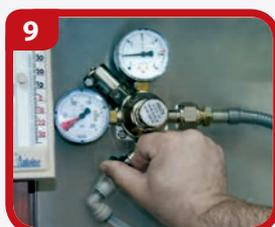
9 Откройте подачу газа на редукторе и отрегулируйте давление.
