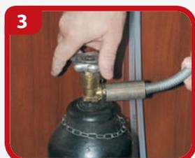
3 Закройте вентиль на баллоне CO<sub>2</sub> по часовой стрелке.
